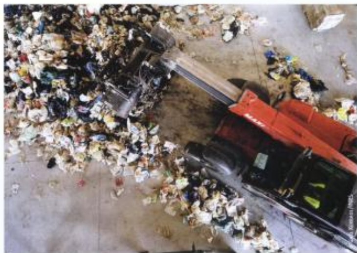
Les déchets ultralégers vont être broyés pour produire un combustible pour les cimenteries.
