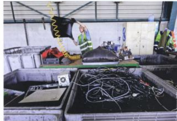
Dans le centre de transit, les différents constituants de déchets d'équipements électriques et électroniques sont séparés.
